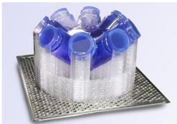
Figura 17. Piezas fabricadas mediante estereolitografía, con sus correspondientes soportes
