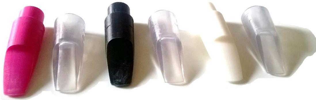
*Figura 47. Boquillas B9, B14 y B21 fabricadas en ambos materiales*
