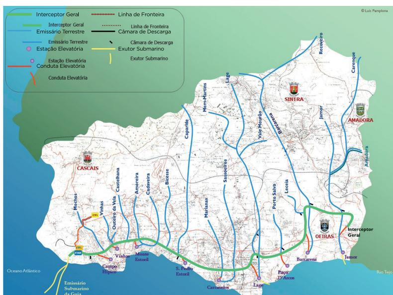
FIGURA 40. Sistema de drenagem em alta (AdTA)
