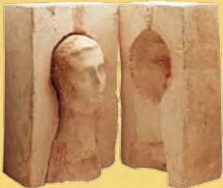
5 - se separan las piezas del molde de yeso (así siempre se conserva un molde con el que repetir el proceso) y sobre el alma, recubierto ahora de cera y con clavos, se forma otro
