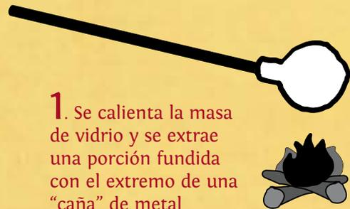
**1.** Se calienta la masa de vidrio y se extrae una porción fundida con el extremo de una “caña” de metal
